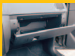
Schowek dwukomorowy z funkcją chłodzenia
