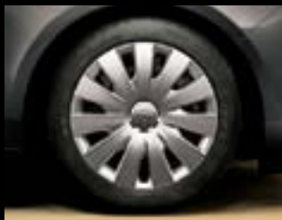
Stalowe obręcze kół z kołpakami 17 x 7", opony 225/50 R 17 (PWP & NQ1). Standard w wersji Enjoy.
