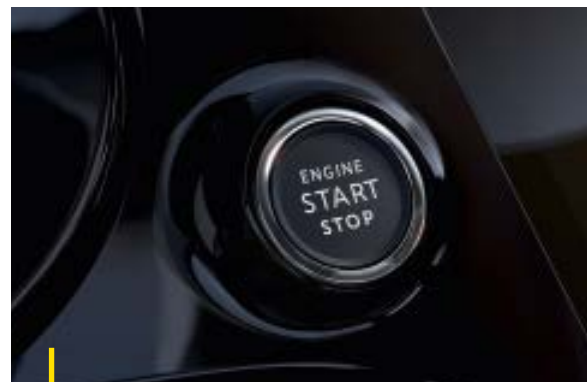
OPEN AND START System automatycznego odblokowywania zamków drzwi i sterowania zapłonem umożliwia wsiadanie do auta i uruchomienie silnika bez wyjmowania kluczyka. Wystarczy, że masz go po prostu przy sobie: w kieszeni czy w torbie.
